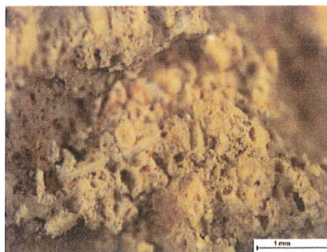
Εικ. 48. Οπτική μικροσκοπία. Διακρίνεται ο βιοκλαστικός χαρακτήρας του λίθου.
